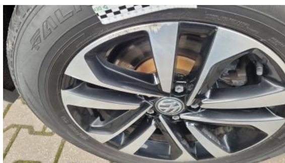
Fot. 40 Felga aluminiowa tylna P - Rysa/odprysk 1
