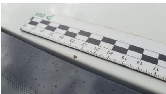
Fot. 43 Dach - Rysa/odprysk 1
