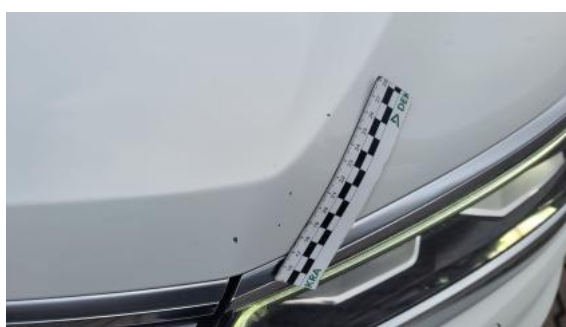
Fot. 36 Pokrywa komory silnika - Rysa/odprysk 1
