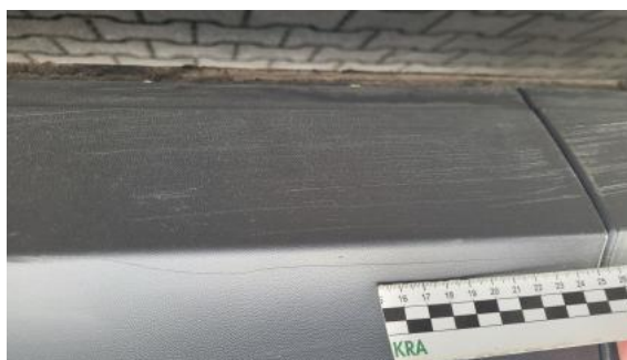
Fot. 38 Listwa drzwi przednich P - Rysa/odprysk 1
