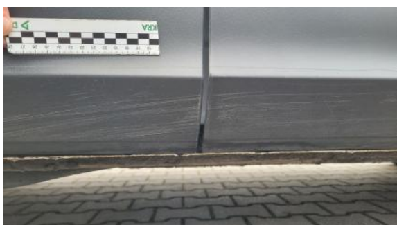
Fot. 39 Listwa drzwi tylnych P - Rysa/odprysk 1
