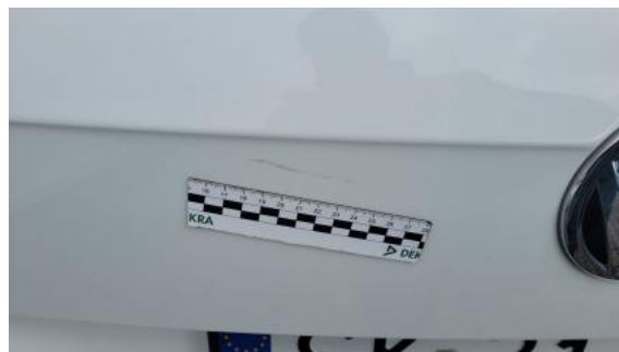
Fot. 42 Pokrywy bagażnika - Rysa/odprysk 1
