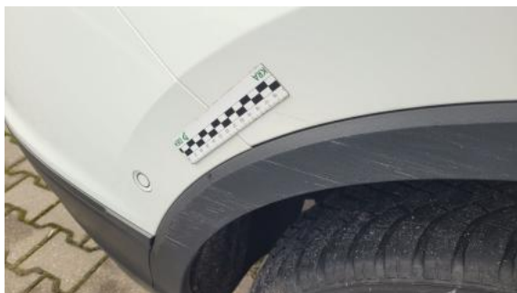
Fot. 41 Listwa krawędzi błotnika tył P - Rysa/odprysk 1
