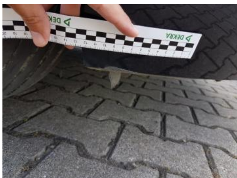
Fot. 25 Zderzak (Rysa/Odprysk)
