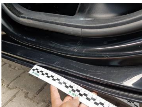
Fot. 37 Próg lewy (Rysa/Odprysk)
