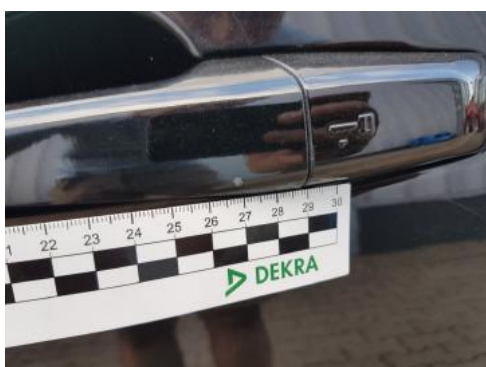
Fot. 39 Klamka drzwi prz. L (Rysa/Odprysk)
