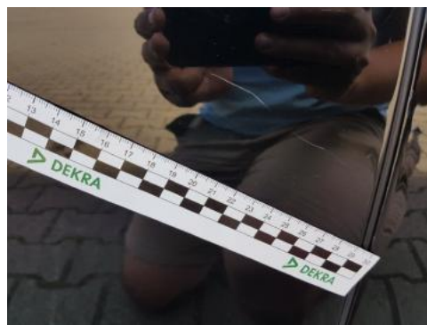
Fot. 34 Drzwi tylne prawe (Rysa/Odprysk 1)
