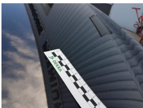
Fot. 27 Pokrywa komory silnika (Rysa/Odprysk)
