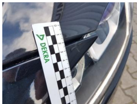
Fot. 26 Zderzak (Wgniecie./Odształ.)
