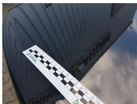
Fot. 36 Pokrywa bagażnika (Rysa/Odprysk)
